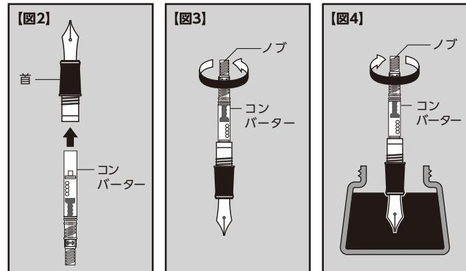
※カートリッジに取り替える場合は、コンバーター内部に残ったインキを空にしてから、ペン先を上に向けて、コンバーターをまっすぐ又は時計回りに回しながら、静かに抜いてください。
